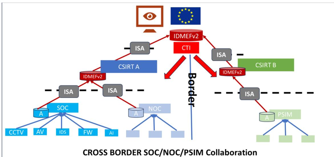
Sur le schéma ci-dessus les modules ISA représentent le filtrage éventuel des informations partagées par des SOC's de SOC's nationaux vers un SOC européen permettant de détecter des attaques combinées sur plusieurs opérateurs au niveau national et européens ainsi que le partage de nouvelle « Threat Intelligence »
